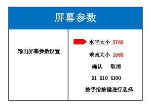
设置屏幕参数,设置水平大小和垂直大小为 LED 屏实际点数,点击"确认"完成参数设置注;可以通过输入数字按键直接输入,或通过旋钮进行参数设置,通过手指按键可选择步长导航模式,选择"多画面设置",点击 OK 进入
