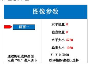
第五步:点击"MENU",返回主菜单界面,进入菜单-高级-常用功能-局部显示(或使用前面板 FUNC 按键可快速进入常用功能,选择局部设置),进入局部显示设置界面,设置每个信号源的局部截取的大小以及位置。
